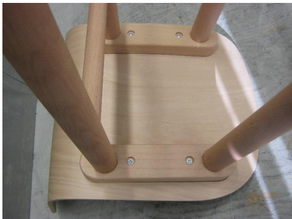
Foto 7: Proefstuk 210594-1 – kruk Beech Shell – detail bevestiging zitting.
