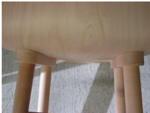
Foto 8: Proefstuk 210594-1 – kruk Beech Shell – detail bevestiging rug-zitting.
