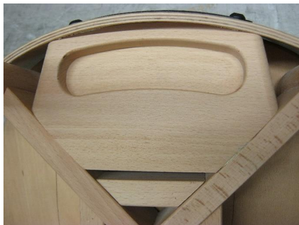
Foto 6: Proefstuk 180225-2 – hoge kruk Beech Boy-4PT – detail onderaanzicht bevestiging rug
